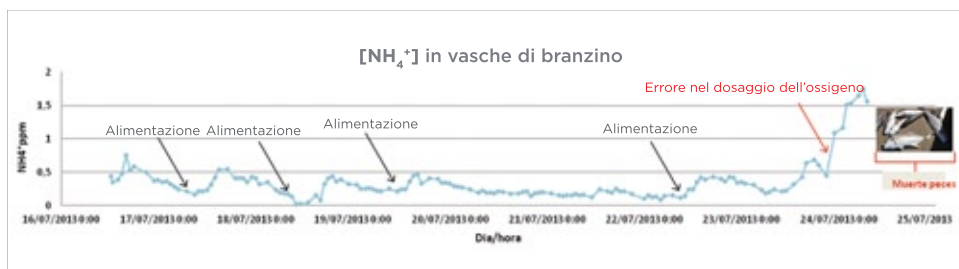
Grafico. Esempio di monitoraggio della concentrazione di ammonio in vasche di branzino
